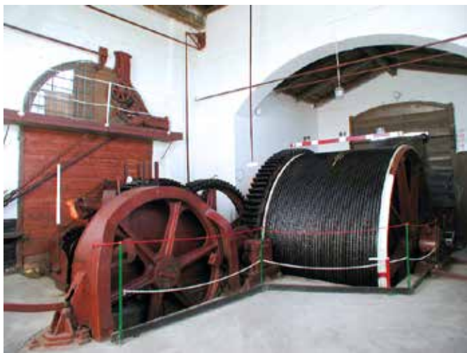
Maszyna wyciągu linowego pochylni Jelenie o napędzie z koła wodnego z 1860, foto Stanisław Januszewski
