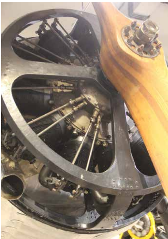
Silnik rotacyjny Siemens-Halske Sh.III zamontowany w eksperymentalnym, prototypowym samolocie do lotów wysokościowych Albatros H.1 z 1918 roku, ze zbiorów Muzeum Lotnictwa Polskiego w Krakowie. foto A. Blachnicka
