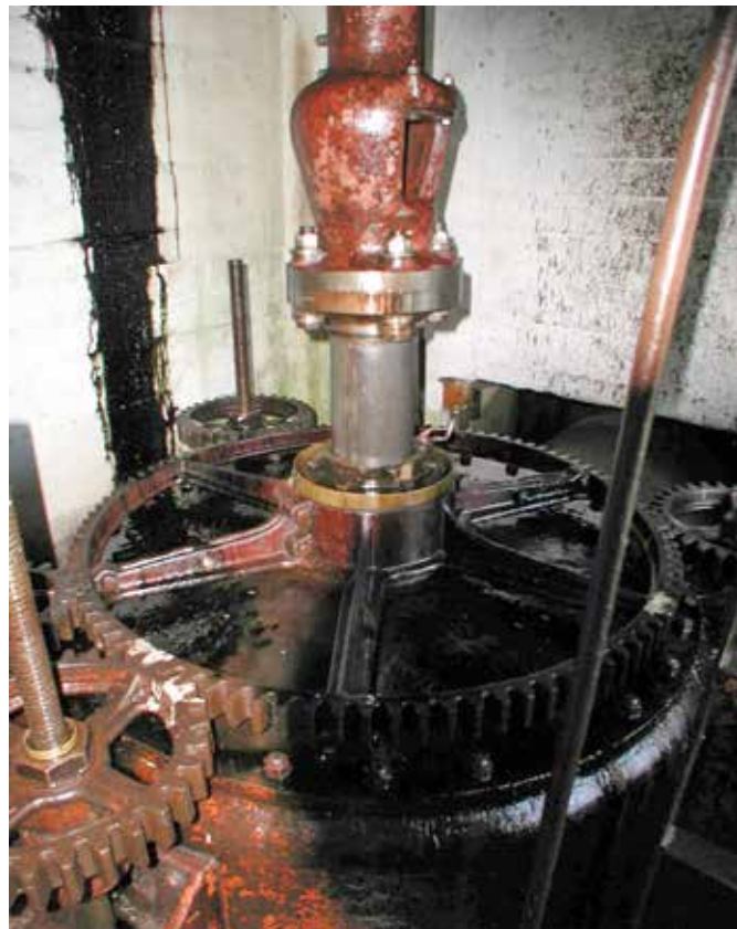
Przekładnia napędu z turbiny na wyciąg linowy w maszynowni pochylni Całuny z 1881 r., foto Stanisław Januszewski
