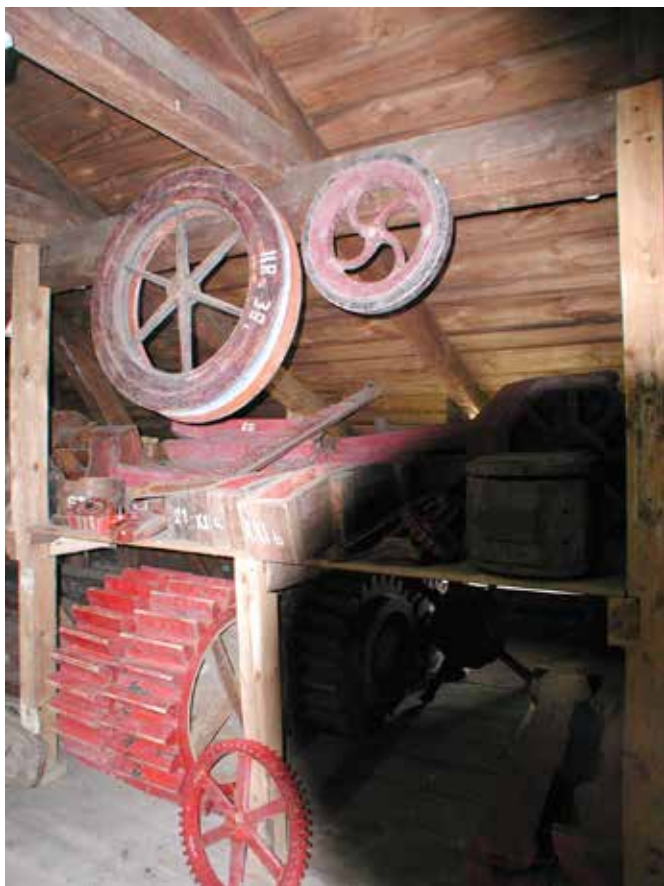
Buczyniec. Modele elementów składowych wyciągów linowych i kół kierunkowych/zwrotnych z 1860 r, w magazynie pochylni, foto Stanisław Januszewskii
