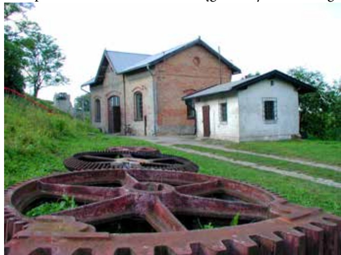
Zapasowe przekładnie i koła kierunkowe wyciągu linowego pochylni Całuny i innych wykonane w latach 50/60. XX w. wg oryginalnych wzorów, foto Stanisław Januszewski
