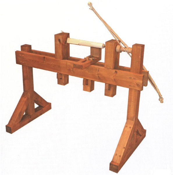
Tokarka napędzana układem smyczkowym
