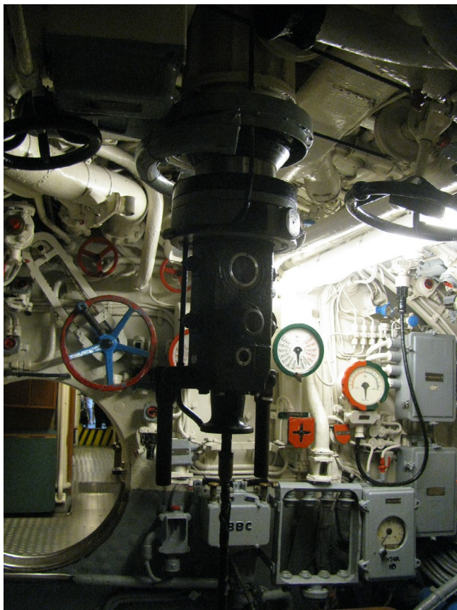
„Oczy” okrętu podwodnego – perwiskop
