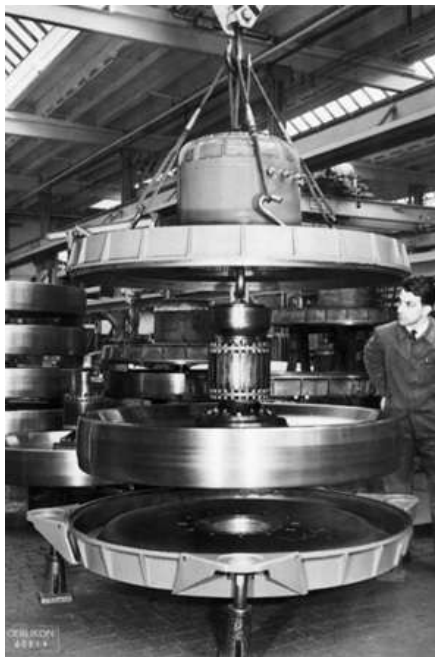
Akumulator kinetyczny w czasie montażu w zakładach Oerlikon
