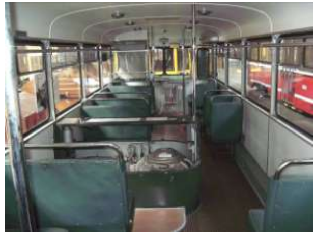
Wnętrze żyrobusu. Pod zdemontowaną osłoną widoczny fragment akumulatora kinetycznego.
