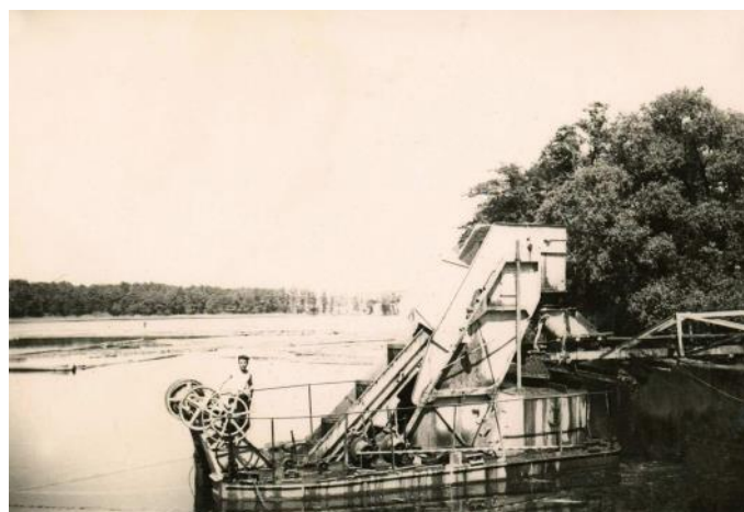
Fot. 5 Pogłębiarka kubłowa Nadzoru Wodnego w Ostródzie – lata 50. XX w. Ze zbiorów M. Rucińskiej
