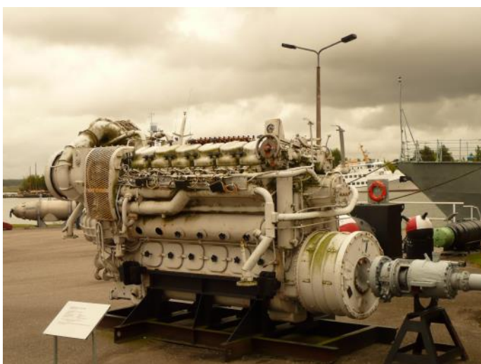
Fot. 2. Silnik wysokoprężny typu 40DM
