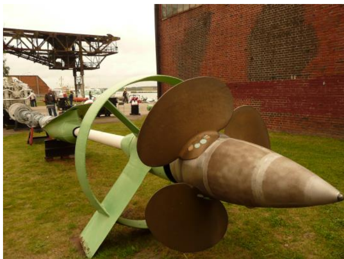
Fot. 4. Śruba napędowa; korpus i łopaty
