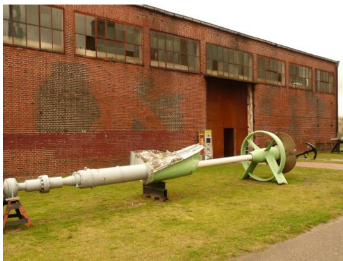
Fot. 3. Widok wału napędowego z łożyskiem, kołnierzymym łączeniem segmentów i dławnicą umożliwiającą wyprowadzenie wału poza kadłub
