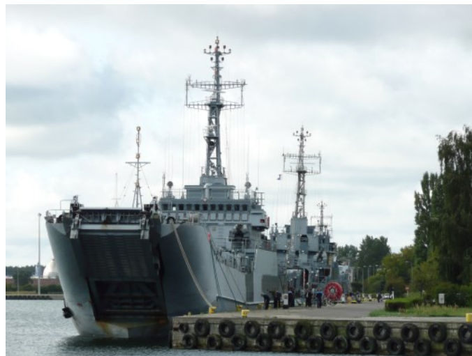
ORP "Gnieszno" w widoku od przodu. Wyraźnie widoczna jest opuszczana rampa roz- i załadunkowa
