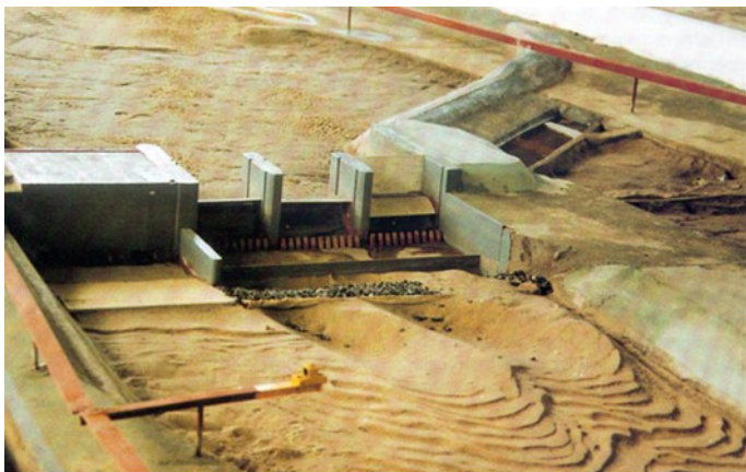
Badania modelowe stopnia wodnego Malczyce w Laboratorium Hydrotechnicznym Politechniki Wrocławskiej (poniżej jazu widoczny wybór i tworząca się erozja dna spowodowana energią wody).
