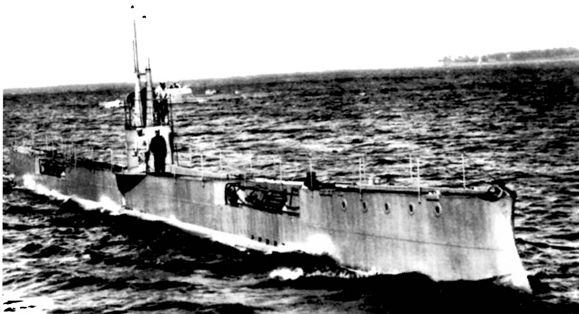
Okręt podwodny „Akula” z wyrzutniami torpedowymi Drzewieckiego, 1909
