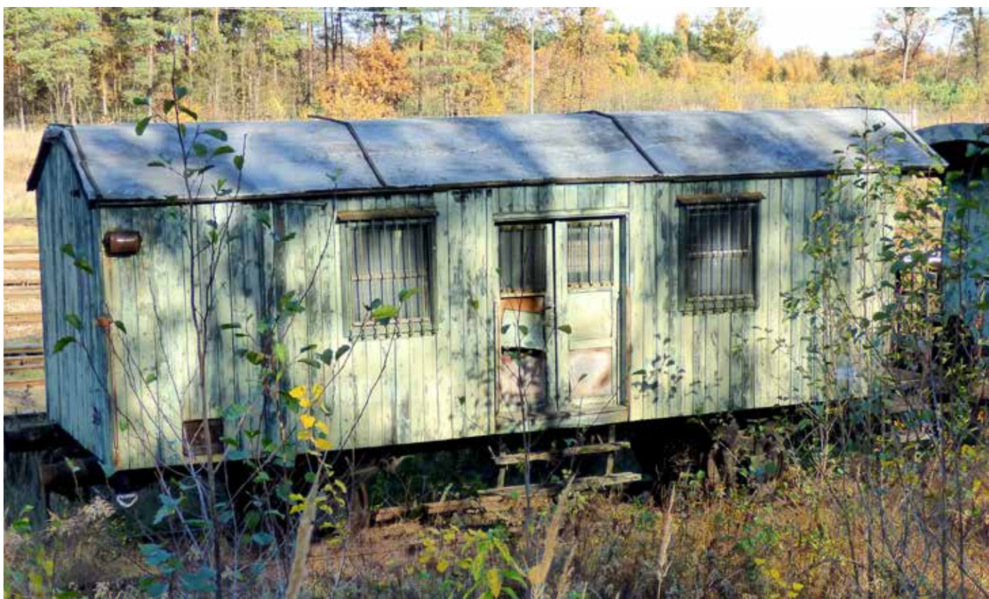
Wagon gospodarczy nr Hk 8366, na podwoziu wagonu towarowego pochodzenia węgierskiego
