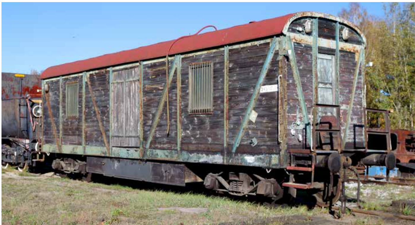
Czteroosiowy wagon gospodarczy nr 8327, na podwoziu wagonu towarowego budowy amerykańskiej
