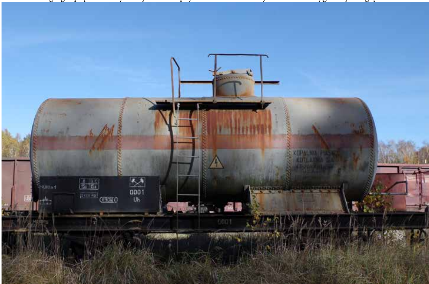
Cysterna dwuosiowa standaryzowanej budowy niemieckiej numer Uh 0001
