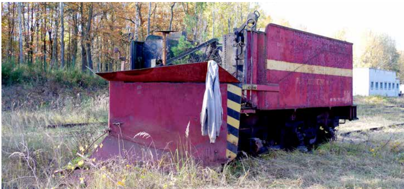
Plug odśnieżny nr 469 zbudowany na bazie tendra parowozowego typu 12C1
