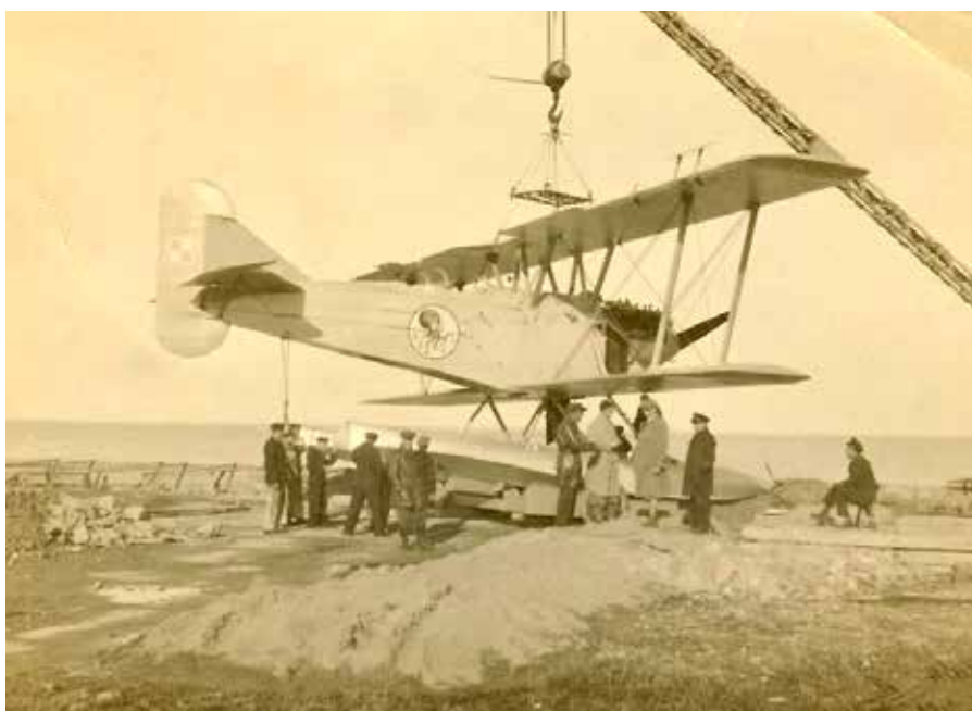
Pierwszy hydroplan polskiej konstrukcji - wodnosamolot liniowy typu R-VIII bis/ hydro „Lublin” nr 801 na kranie w bazie Morskiego Dywizjonu Lotniczego - źródło: zbiory J. Butkiewicza
