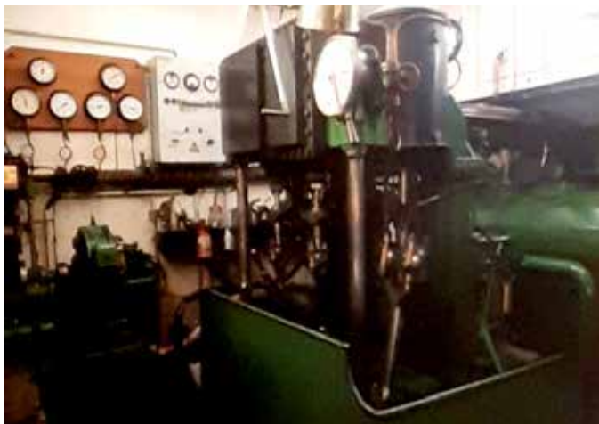
Dwucylindrowy silnik parowy statku.
