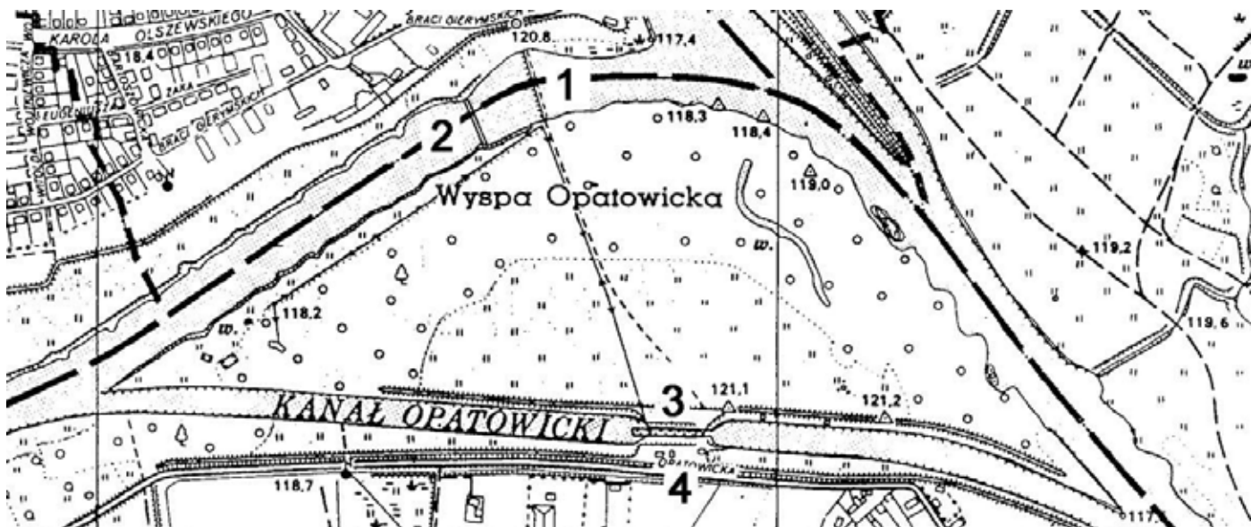
1 – jaz kozłowo-iglicowy (nieczynny), 2 – jaz sektorowy, 3 – śluza komorowa (mała), 4 – zabudowa przystopniowa.
