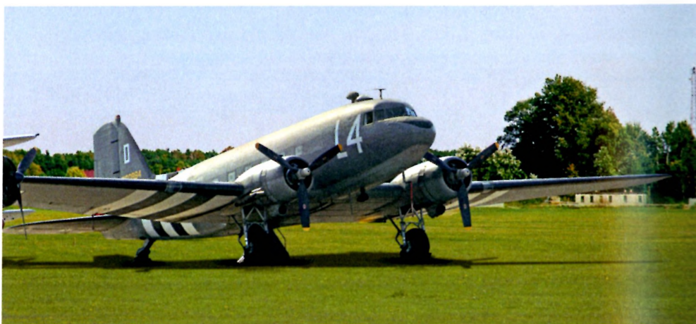
Douglas C-47 Skytrain/Dakota, Shoreham Airshow 2015, foto: Marek Ligęza. Był najliczniej produkowanym samolotem transportowym w historii. Łączna produkcja DC-3 i C-47 wyniosła ponad 17000 samolotów. Tylko produkcja DC-3/C-47 oraz B-24 Liberator pochłonęła większość wyprodukowanych silników P&W R-1830 Twin Wasp.
