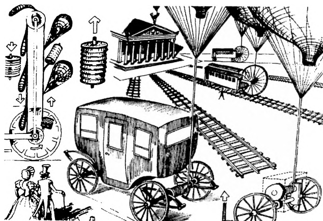
Balon jako silnik i jego różne połączenia z pojazdem czy wyciągarką oraz układ balonu próżniowego pracującego na linii bez końca, na podstawie rysunków zawartych w patencie głównym z 9.10.1839 r. i dodatku z 29.08.1840 r. opracował S. Januszewski
