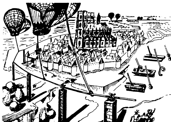
Kolej balonowa gen. Henryka Dembińskiego – system przemieszczania balonu względem ziemi; torowisko i różne wersje sprzęgła łączących balon z traktacją naziemną, na podstawie rysunków patentowych opracował S. Januszewski, Francja – patent z 9.10.1839 r.
